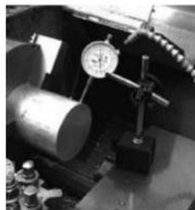
Centrado de pieza en el torno mediante reloj comparador
